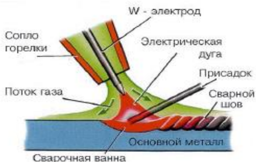
3 Сурет. Аргондоғалы пісіруде жандырғы мен қосымды шыбықтың орналасуы
